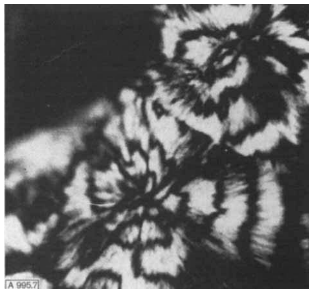
Abb. 7. Polarisationsmikroskopische Aufnahme eines Sphärolithen in Polyäthylenterephthalat [7].
